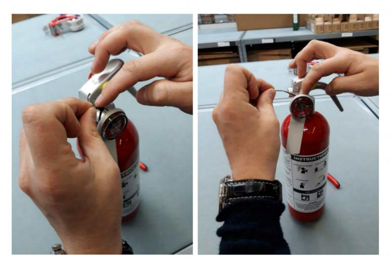
RFID FLAG TAG TIGHTENING FIGURE 6004/GRAPHIC 26-24-01-991-018-A01
